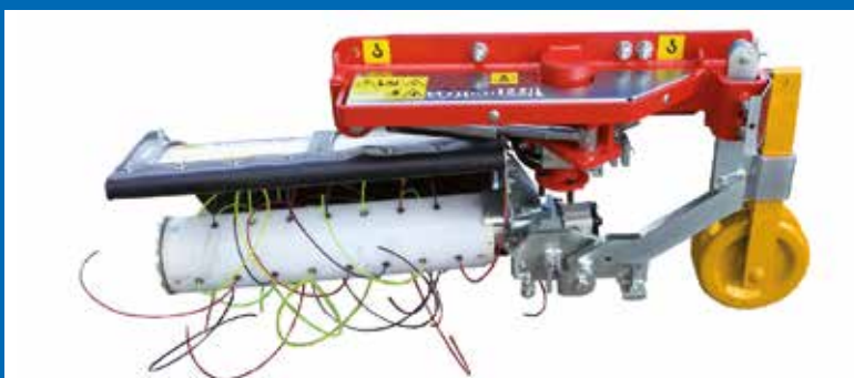
Trinciaerba a fili verticali per Expo Vertical wires mower for Expo Hache-herbe à fils verticaux pour Expo Picadora de hierba de hilos verticales para Expo
