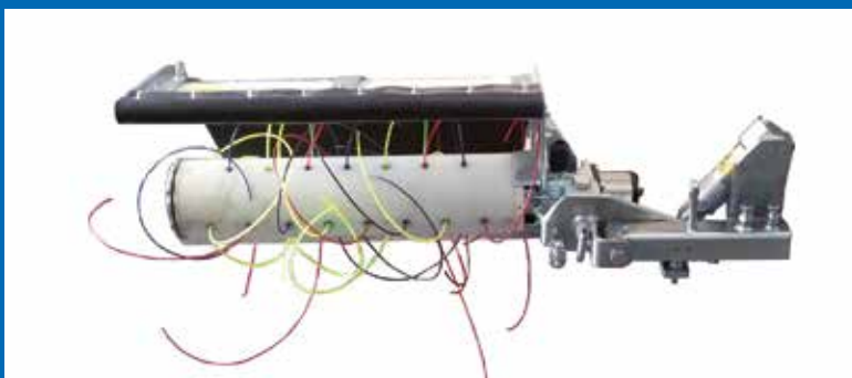
Trinciaerba a fili verticali per Frutteto Vertical wires mower for Orchard Hache-herbe à fils verticaux pour Arboricole Picadora de hierba de hilos verticales Frutales
