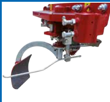
Vomere scalzante cm 45 / 55 Plant lifting ploughshare cm 45 / 55 Soc déchausseuse cm 45 / 55 Reja de arado arrancadora cm 45 / 55
