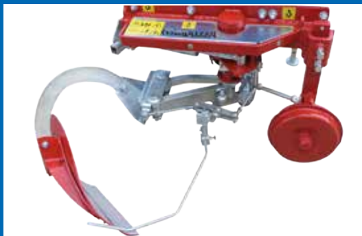
Kit aratro scalzante Plant lifting plough kit Kit charrue déchausneur Kit arado arrancador
