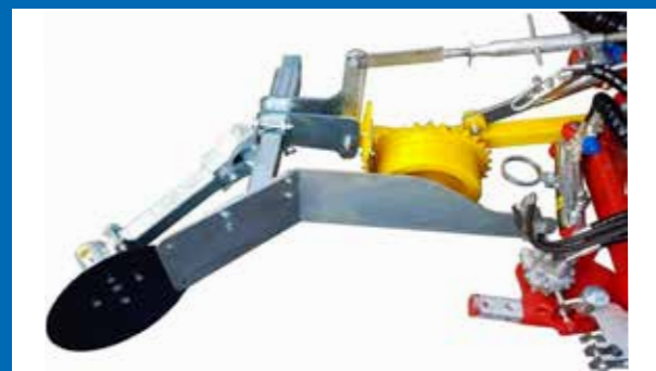
Paraterra per Frutteto (anche con disco delimitatore) Ground cover for Orchard (also with delimiting disc) Défense terre pour Arboricole (aussi avec disk delimitateur) Paratierra para Frutales (también con disco delimitator)
