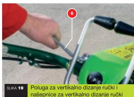
SLIKA 19 Poluga za vertikalno dizanje ručki i naljepnica za vertikalno dizanje ručki
