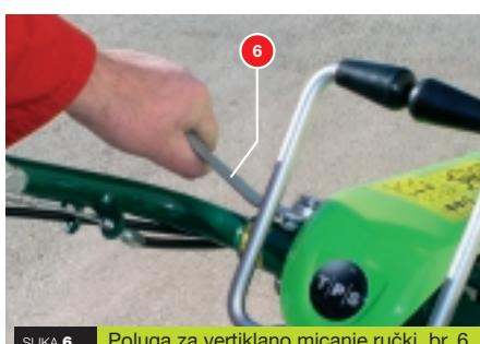
SLIKA 6 Poluga za vertikalno micanje ručki, br. 6
