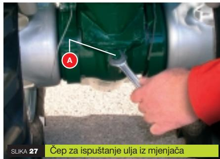
SLIKA 27 | Čep za ispuštanje ulja iz mjenjača
