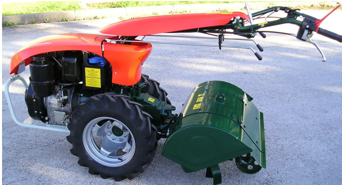
Sl.1 Motokultivator s kopačicom i točkićem za prijevoz
